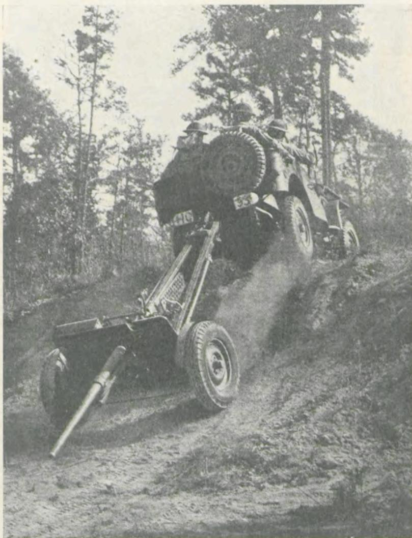
*Graças às suas quatro rodas motoras, os «Jeeps» rebocam com grande facilidade canhões anti-carro, através de terreno acidentado*
