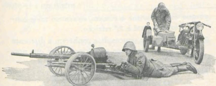
O canhão automático **Madsen** de 20<sup>mm</sup>, sôbre «side-car», pode fazer fogo montado sôbre êste, ou no terreno, sôbre o reparo a que está permanentemente ligado
