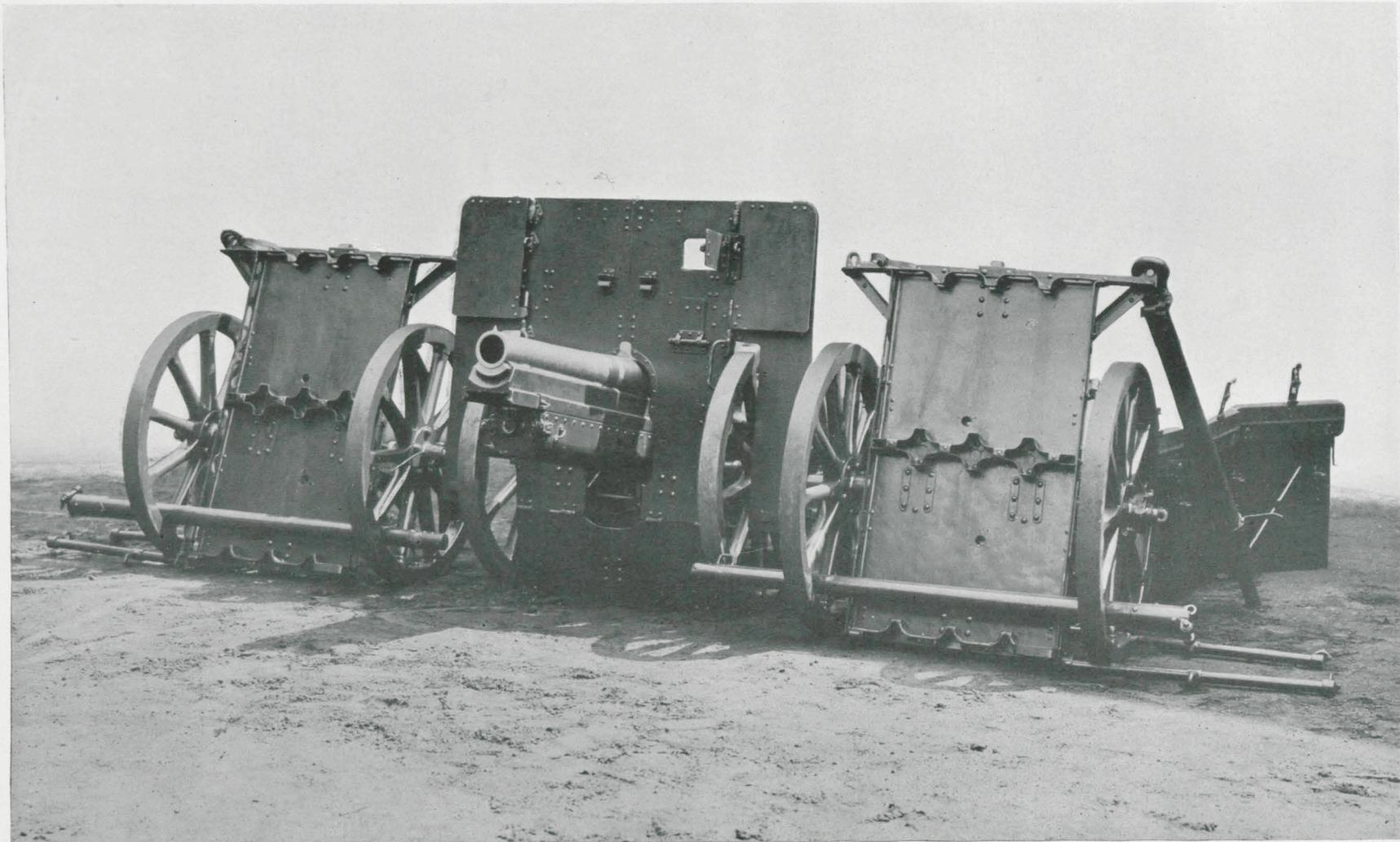
Geschütz in Feuerstellung mit Munitionskarren als Munitionsschild.
