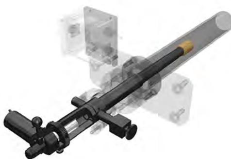
**Fig. 4 – Dispositivo de Calibre Reduzido montado na câmara de obus**
