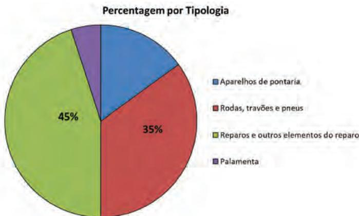
Figura 3 – Distribuição das avarias registadas no obus 15,5 rebocado M114.
