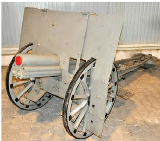
Figura 3 – Peça 7 cm MTR m/1906 com os escudos montados..
