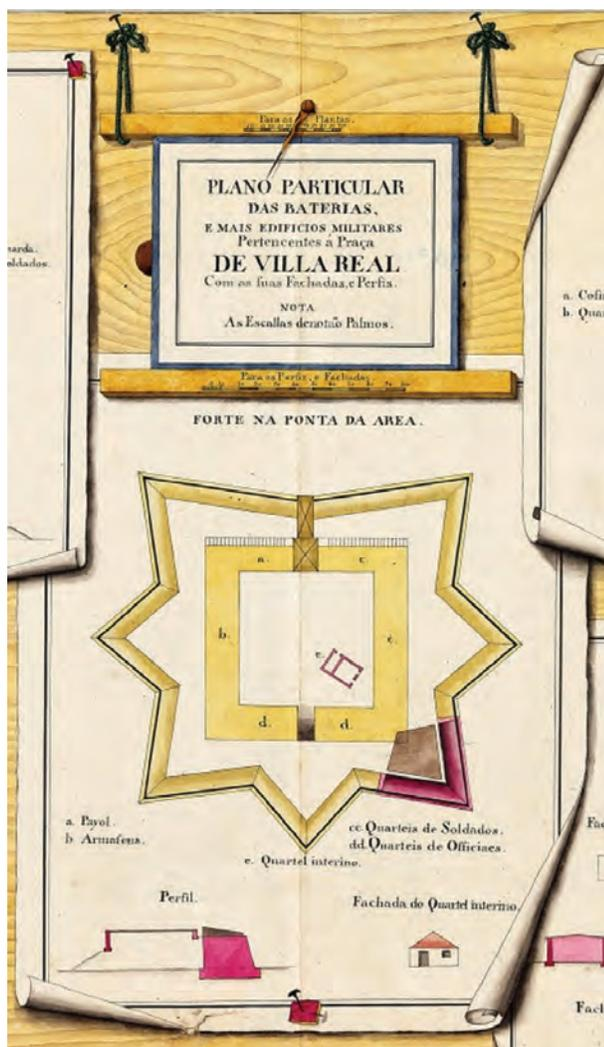
na mesma parede, virada para a posição. A *Fachada do Quartel interino* sugere uma pequena edificação com telhado de quatro águas. Numa planta de 1809, sabemos que esta instalação tinha 2,8 por 7 braças, o que significa que foi feito um esforço para tornar esta bateria independente das restantes, com instalações para pessoal, palamenta e munições.
