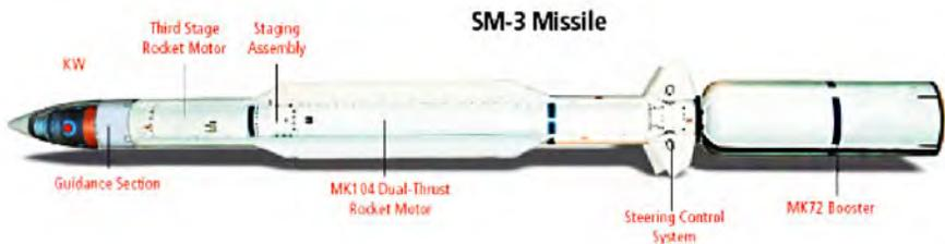
Figura 6 – Míssil SM-3 detalhado pelos seus componentes
