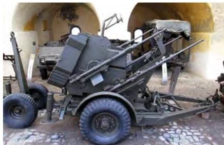
**Metralhadora quadrupla AA 20mm,
