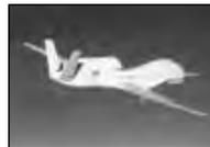
(2) **MALE** – (Medium Altitude Long Endurance), estas aeronaves poderão ou não necessitar de uma pista, podem ser lançadas por um sistema propulsor e capturadas por uma rede. Podem ter asa fixa ou rotor (NATO, 2008d);
