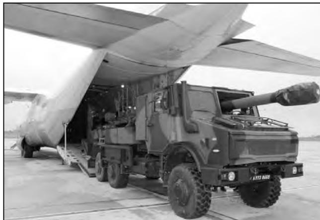
*Figura 2 – CAESAR aerotransportado em C-130.*
