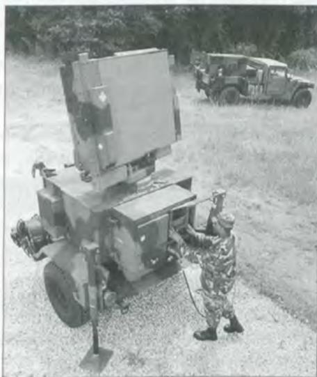
*Fig. 5 – O radar Sentinel (AN/MPQ-64) tem um alcance de 75 km e equipa todas as unidades SHORAD do Exército dos EUA.
