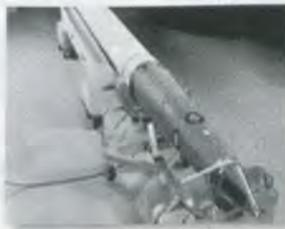
O *Canister* do míssil consiste numa armadura selada herméticamente, onde está alojado o míssil e que funciona também como tubo de lançamento.
