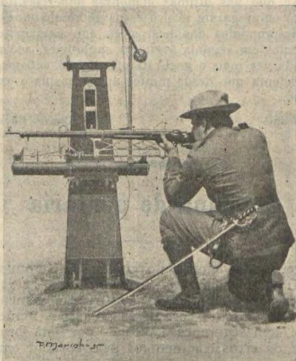
todas as direcções, e durante a pontaria não tem outro ponto de apoio alem dos braços e do hombro do atirador. O aparelho de suspensão da arma é equilibrado por um peso movel, para que não exerça influencia alguma sobre o atirador, ficando este sómente carregado com o peso da espingarda.
