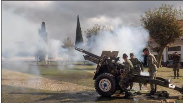
Teve lugar no RAAA1, em 04NOV15, uma série de testes de ensaio às munições de salva de obus 88mm, utilizando para tal o obus *QF Pounder-25* 88mm. Estes testes foram efetuados com a finalidade de avaliar a pólvora negra recentemente adquirida pela Direção de Material e Transporte, assim como a quantidade necessária para a manufatura do cartucho de salva 88mm M/943.
