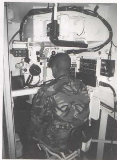
Fig. 4 - Simulador de tiro para o apontador.
