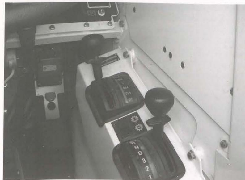
Fig.7 - Alavanca da caixa de transferência e alavanca da caixa de transmissão.
