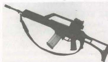
A nova G36/G36E é uma arma com um sistema modular de calibre 5,56mmX45mm, desenhada com o intuito de o Exército alemão substituir a sua espingarda automática G11. Construída praticamente com base num polímero de fibra reforçada e funcionando com um sistema auto regulado de gás, a G36/G36E confere um baixo peso aliado a um grande desempenho e uma muito baixa manutenção, podendo o cano ser trocado por um maior (carabina).
