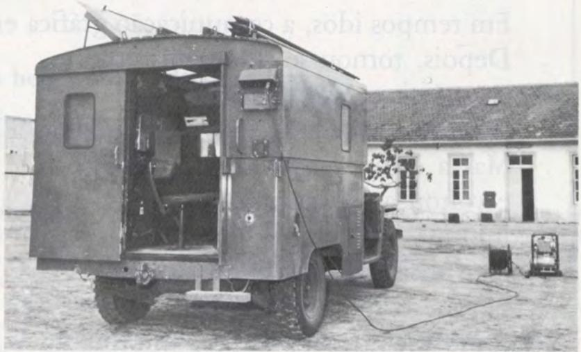
mentação, com cablagem apropriada, poderia ser feita a partir do sector de baterias ou de um grupo electrogéneo. A viatura tinha possibilidade de actuar como oficina móvel realizando-se o trabalho no seu interior ou de permitir a instalação de uma oficina tipo fixo com bancadas montadas no exterior utilizando tampos assentes em cofres de madeira.
