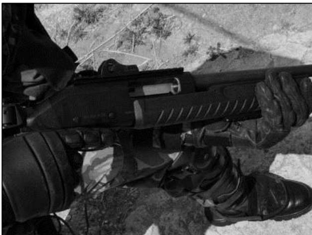
Figura F-4 – Verificação da janela de ejeção
