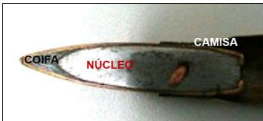
Figura 2-1 – Pormenor de corte de munição perfurante
