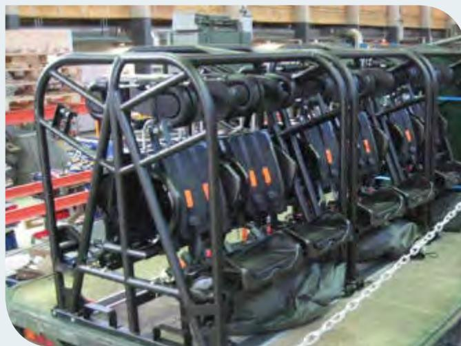
**Figuras 2 e 3** – Caixa de carga com sistema ROPS na configuração de transporte de carga ou pessoal
