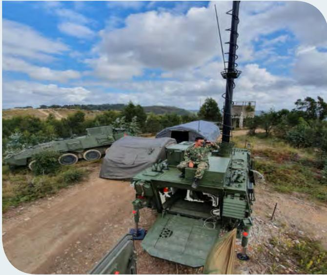
**Figura 3** – Repetidor de feixes hertzianos, na Serra de Valongo.
