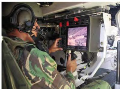
Figura 2 e 3 - Estação de armamento da VBR PANDUR II 8X8 RWS (PRT)
