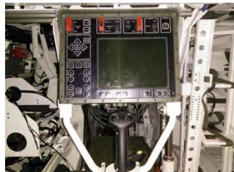
Figura 5 -LCD e alavanca de controlo da RWS da VBR PANDUR II 8X8 RWS (PRT)
